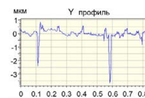
Рисунок 3 – СЭМ-изображение (а) и профиль (б) поверхности модифицированного висмутом стального диска после алмазного выглаживания
